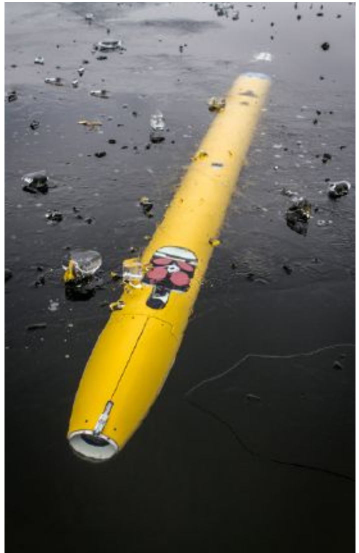
Das autonome Unterwasserfahrzeug Leng könnte eine kilometerdicke Eisdecke auf dem Jupitermond Europa durchdringen, unter der ein Ozean vermutet wird.
